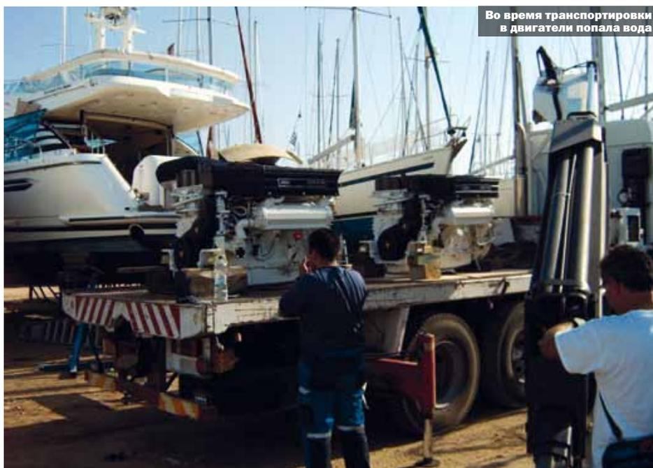
Во время транспортировки в двигатели попала вода
